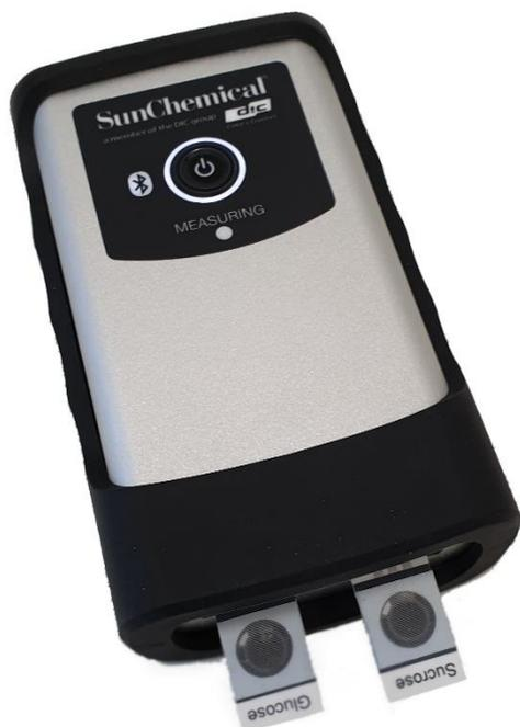
Nehmen Sie die Sensoren mit einer Pinzette aus dem Container und setzen Sie sie in das Modul ein. Tragen Sie dabei Handschuhe. (Pinzette und Handschuhe sind nicht im Lieferumfang enthalten).
