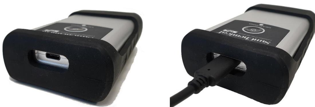
Um den SunSens Potentiostat einzuschalten, drücken Sie die mittlere Ein / Aus-Taste. Ein weißes Licht erscheint um die Taste. Wenn das weiße Licht nicht angezeigt wird, muss das Gerät möglicherweise aufgeladen werden.
