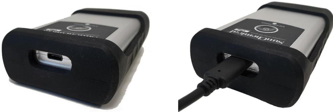
Para encender el potenciostato SunSens, presione el botón de encendido central, aparecerá una luz blanca alrededor del botón. Si la luz blanca no aparece, entonces el dispositivo puede requerir carga.
